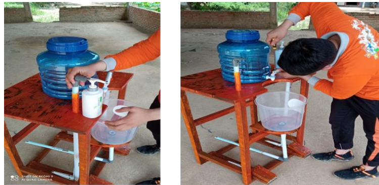
Figur 2. Pemasangan Sistem Dispenser
