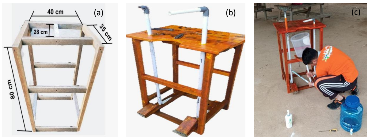
Figur 1. Desain alat cuci tangan berbasis pedal : (a) Kerangka utama beserta ukurannya, (b) Meja alas dan sistem pedal, dan (c) Proses pemasangan saluran pembuangan air
