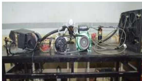
Gambar 11 Alat uji simulasi siklus pendingin
