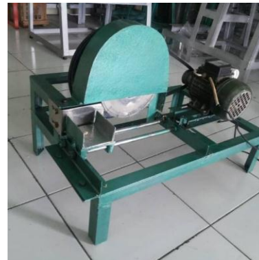
Gambar 2. Mesin Pengiris Tempe Semi Otomatis dengan arah pengirisan vertikal
