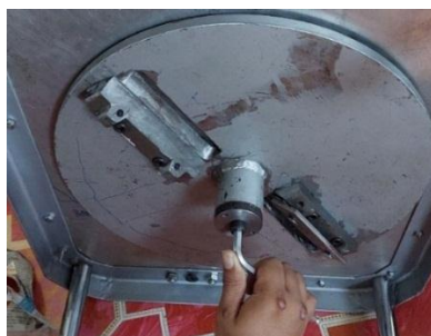
Gambar 12. Pemasangan Piringan Pengiris
