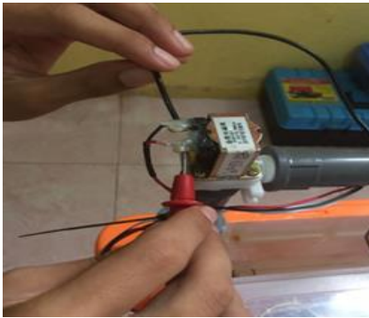
Gambar 25. Pengujian arus dan tegangan solenoid valve
