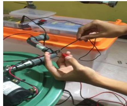
Gambar 24. Pengujian arus dan tegangan pompa air
