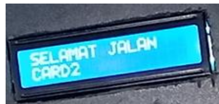
Gambar 19 Tampilan LCD pada pintu keluar parkir saat tag ditempel ke NFC PN532
