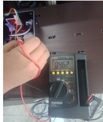
Gambar 26 Pengukuran pengujian sensor infrared
