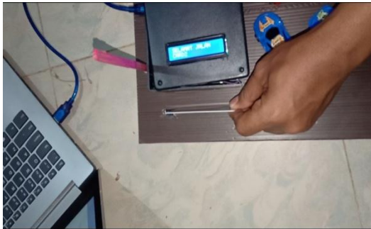
Gambar 24 Kondisi motor servo saat tag ditempelkan ke NFC reader PN532
