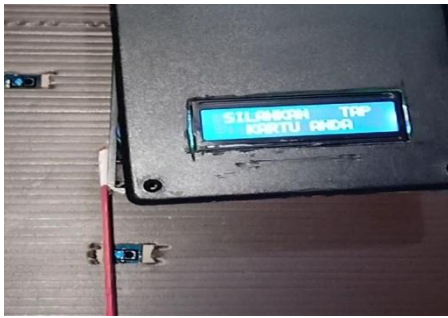
Gambar 20 Posisi awal motor servo palang pintu masuk parkir
