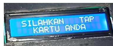
Gambar 13 Tampilan LCD sebelum tag ditempel ke NFC reader PN532
