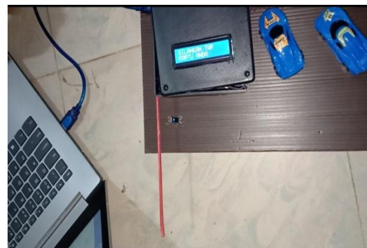
Gambar 23 Posisi awal motor servo palang pintu keluar parkir
