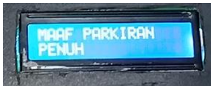
Gambar 16 Tampilan LCD saat slot pada parkir penuh
