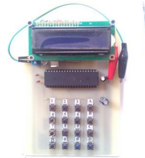
Gambar 4.3 Bentuk Interface LCD 16x2 dan Keypad
