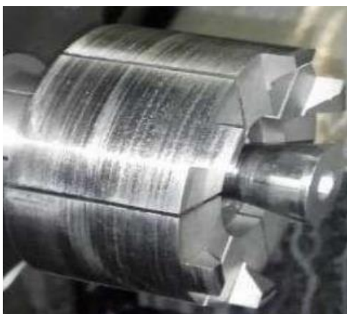
Gambar 4. Kondisi Chuck Collect Setelah Perbaikan (modifikasi)
