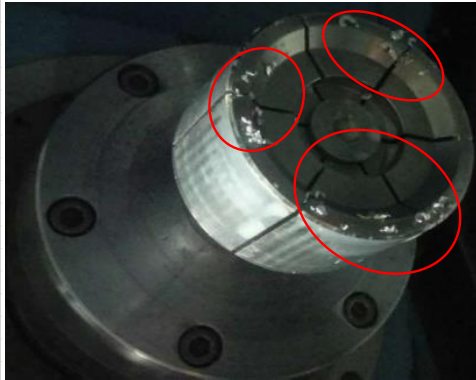
Gambar 3. Kondisi Chuck Collect sebelum perbaikan
