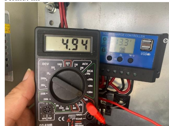
Gambar 18. Pengukuran ampere Berdasarkan pengukuran pada gambar diatas dapat diperoleh data sebagai berikut
